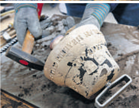
Die Form aus Sand (oben) wird mit Werkzeugen (Mitte) verziert, welche teilweise über 100 Jahre alt sind. Nach dem Giessen (unten) kleben noch Sandreste an der Glocke.
